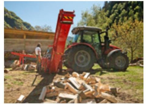
*Les troncs d’arbres sont introduits à l’arrière et il en ressort à l’avant un volume équivalent de bûches.*
