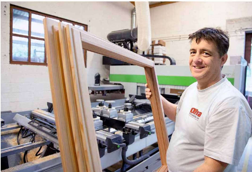
Ce cadre de fenêtre a été découpé par la machine CNC en quelques minutes, sans l'intervention de Matteo Oliva.
